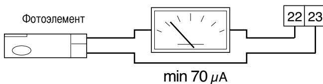
Ток ионизации проверяется с помощью микроамперметра с глубиной шкалы 1000  $\mu\text{A}$  (постоянного тока), который последовательно подключается к фотоэлементу. Как правило, сила тока должна быть не ниже 70  $\mu\text{A}$ .
